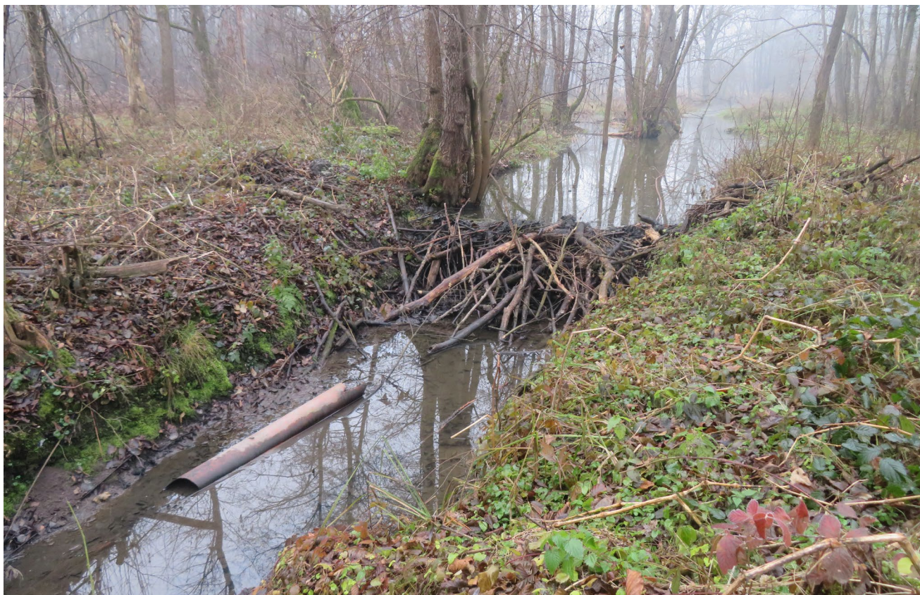
Slika 142. Odlomljen del cevi v strugi vodotoka.
